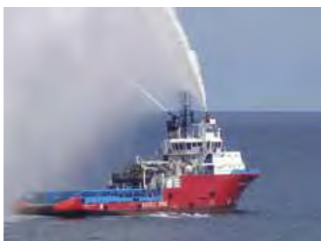
GB com monitores FIFI em funcionamento.
